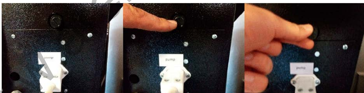
Figure 33: Activarea siguranței termice
