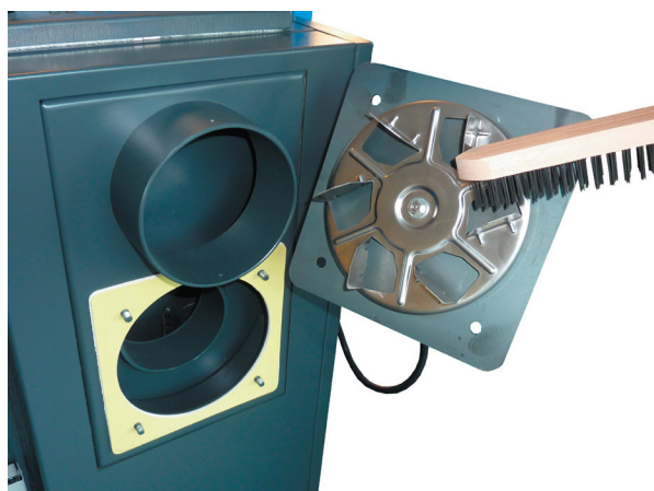
Exemplu de curățare a rotorului și verificarea perpendicularității paleșilor exhaustorului
