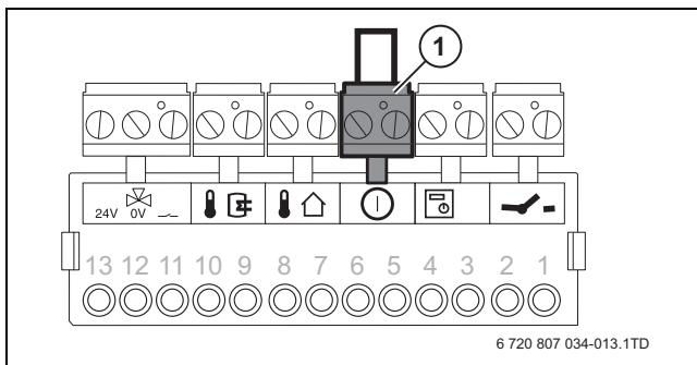
Fig. 32 Racordul unui contact de comutare extern
