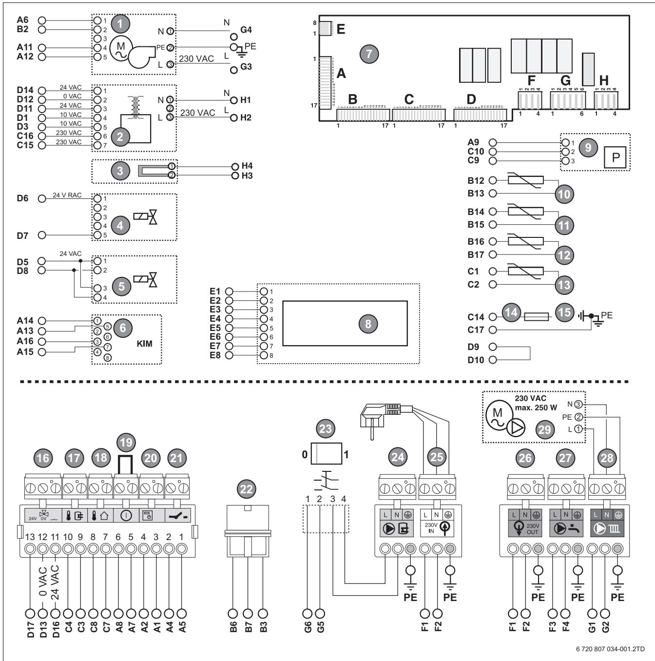
Fig. 5 Schemă electrică
