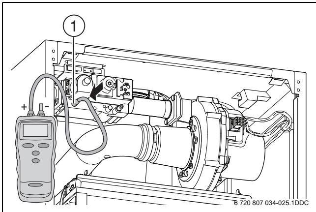
Fig. 44 Raccord al manometrului la tip 100
