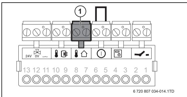
Fig. 33 Conexiunea senzorului pentru temperatură exteroară
