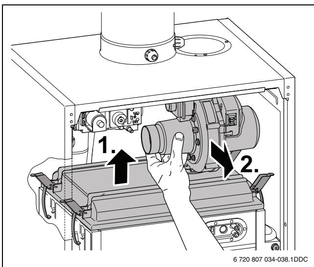
Fig. 54 Îndepărtarea unității de gaz/aer cu capacul arzătorului
