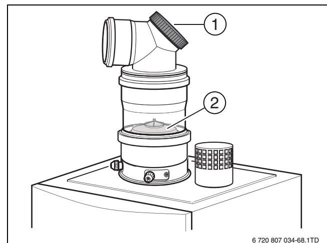
Fig. 69 Verificarea clapetei de suprapresiune a gazelor arse
