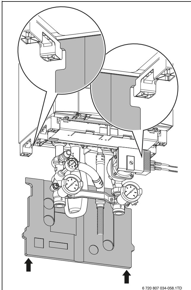
Fig. 22 Montarea peretelui din spate (izolare)
