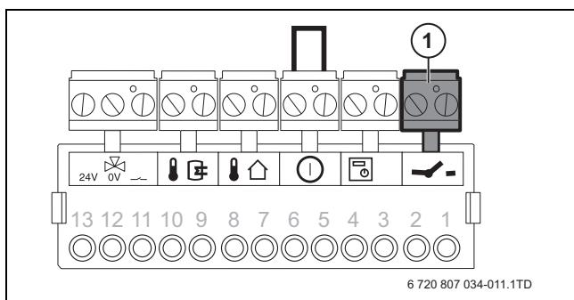
Fig. 30 Racordarea termostatului de cameră de pornire/oprire
