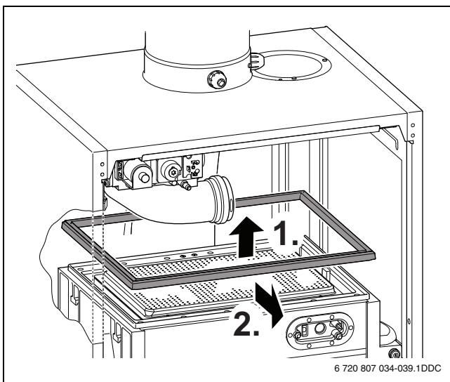
Fig. 55 Îndepărtaarea garniturii arzătorului
