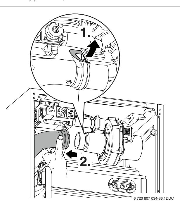
Fig. 52 Desfacerea țevii de aspirare a aerului (lupă: tip 70)
