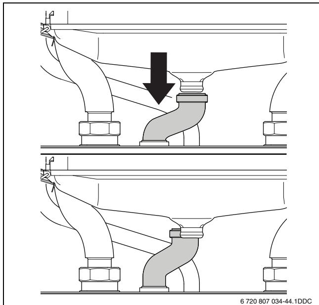
Fig. 62 Îndepărțarea furtunului pentru condensat
