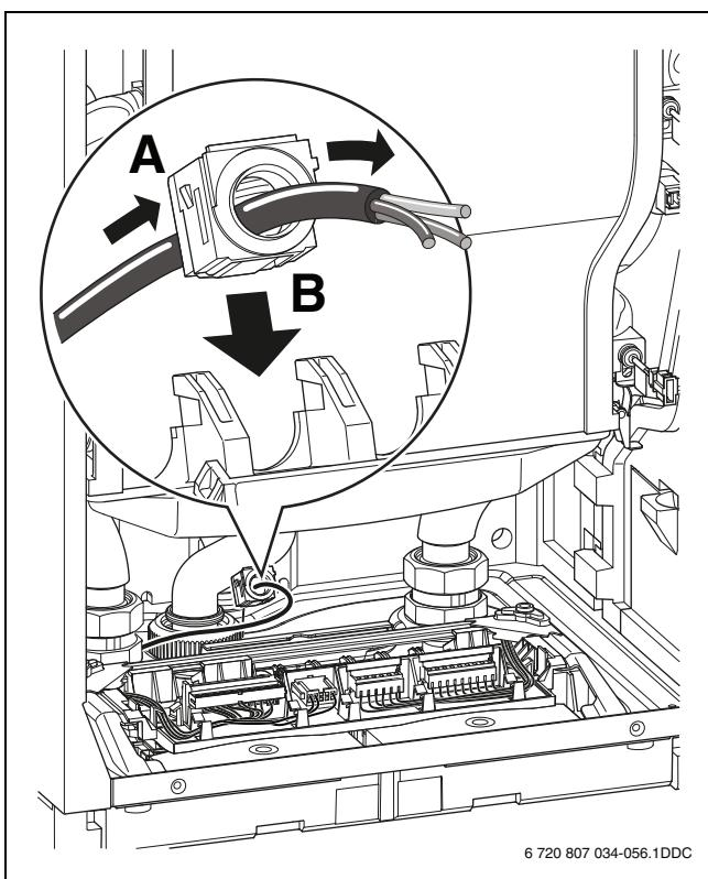
Fig. 28 Conducerea cablului
