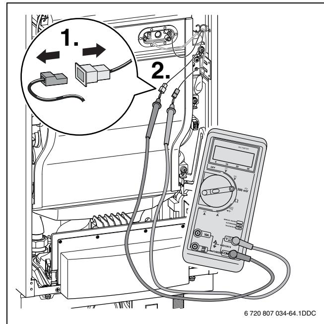
Fig. 48 Racordul multimetrului
