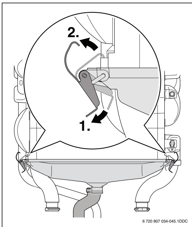
Fig. 63 Deschiderea vanei de condensat cu închideri înclichetate
