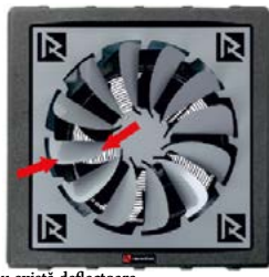
Versiune cu confuzor, nu există deflectoare. Utilizarea difuzorului 360° sau a confuzorului scade debitul de aer cu aprox. 10% și reduce capacitatea cu 5%.
